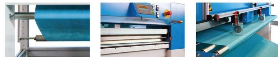
Zusätzliche Längstrenneinheit mit variabler Anzahl an Längstrennmesser zum Herstellen von unterschiedlichster Zuschnitte!
